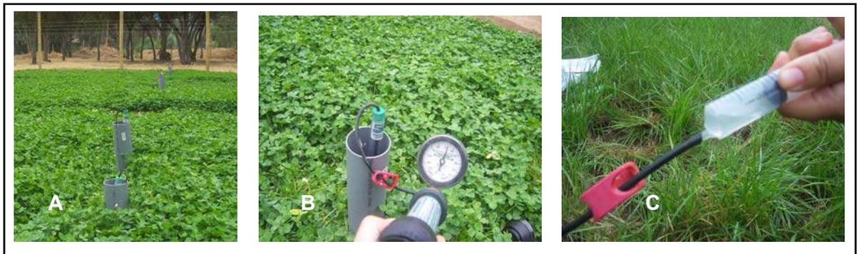
Figura 12. (A) Lisímetros instalados en terreno con protección de pvc; (B) Aplicación de vacío; (C) Extracción de solución suelo con jeringa.
