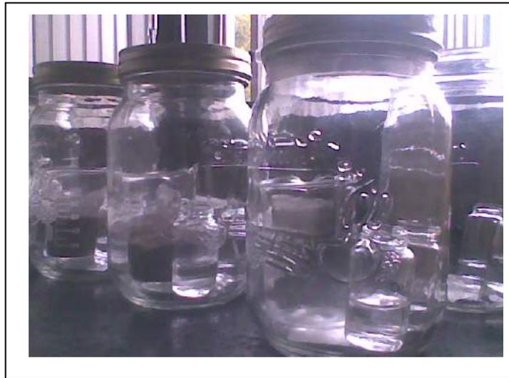
Figura 11. Frascos de vidrio de 1 L conteniendo muestra de suelo, trampa de NaOH y vial con agua destilada.
