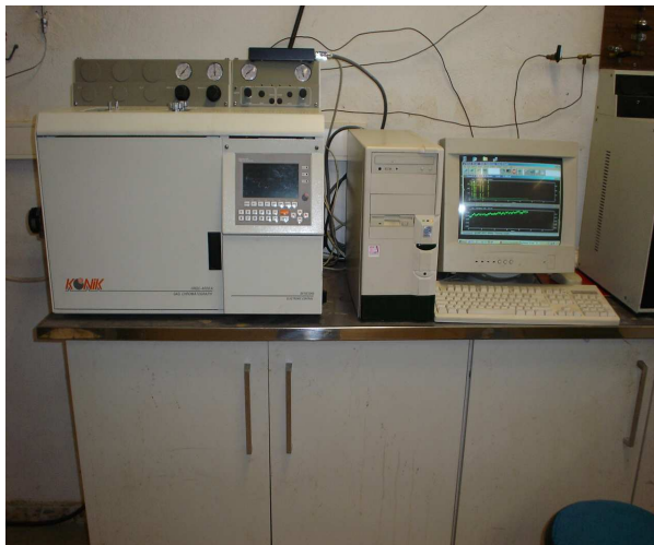
Figura 5.6. Cromatógrafo para el análisis de la fase gaseosa
