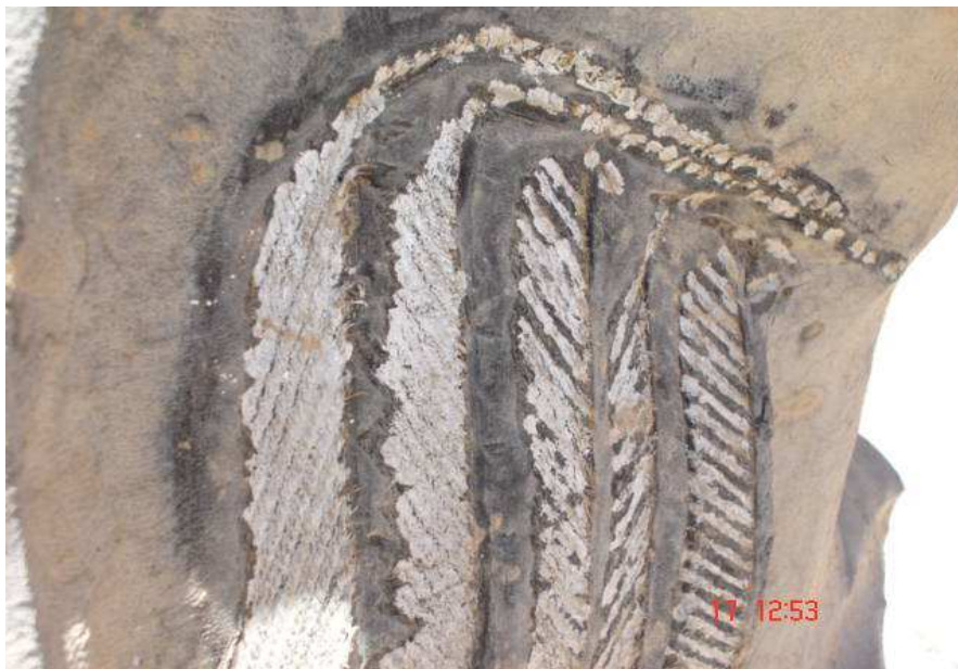
Figura 5.1: Neumático reforzado con mallas de acero 4
