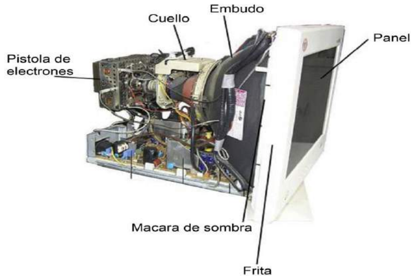
Figura 9. Estructura típica de un TV TRC Fuente: Yu-Gong et al., 2015
